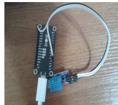
Рисунок 3 – Подключение датчика температуры и влажности к Wi-Fi модулю в разрабатываемой беспроводной системе мониторинга
